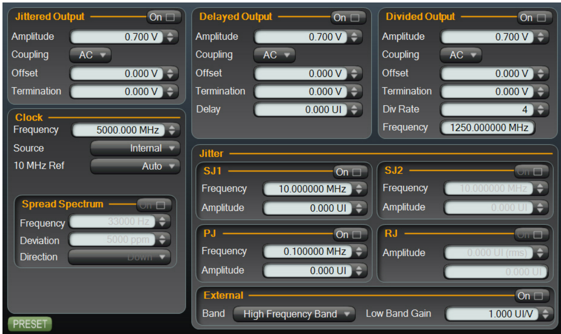
Figure 45. N4972A-CJ0/N4972A-CJ1 control panel
