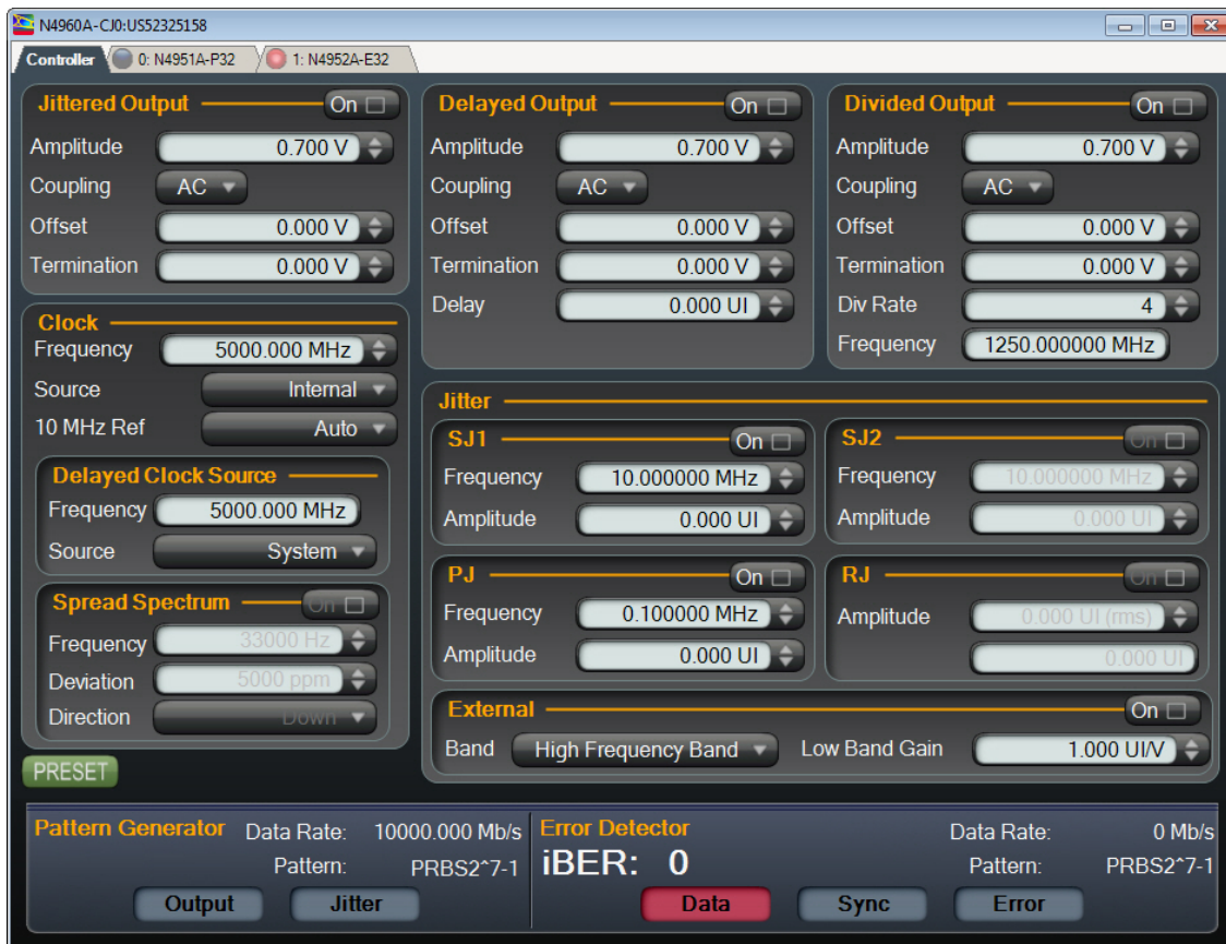
Figure 46. N4960A-CJ0/N4960A-CJ1 control panel
